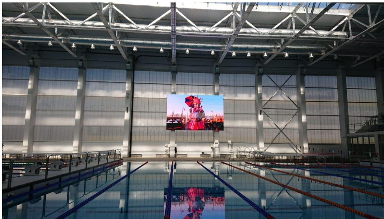
Экран рассчитан на стабильную работу в условиях высокой влажности. Монтаж производился в готовом помещении с наполненной чашей бассейна. Прокладка кабельных трасс в сварной стальной трубе.
